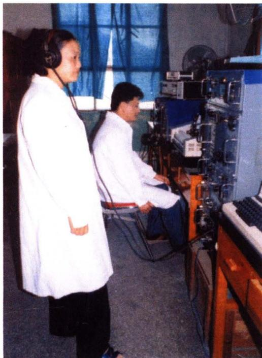
20世纪80年代气象通信设备——单边带接收机、电传机。
