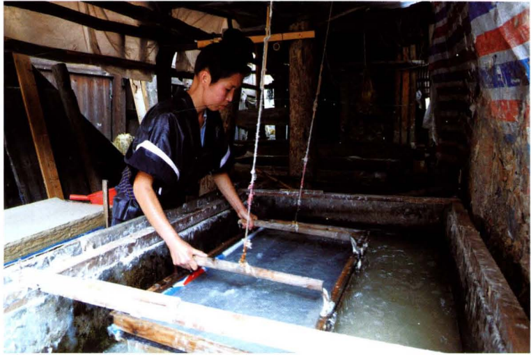
古法造纸流程—— 抄纸 (2007年8月25日 摄)
