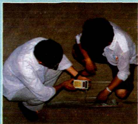
糧食倉庫電阻測溫儀
