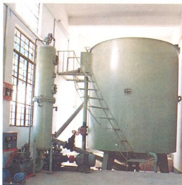
南海县环保设备机械厂研制生产的气浮水处理设备（左）和铬废水处理机（双机串联）。
