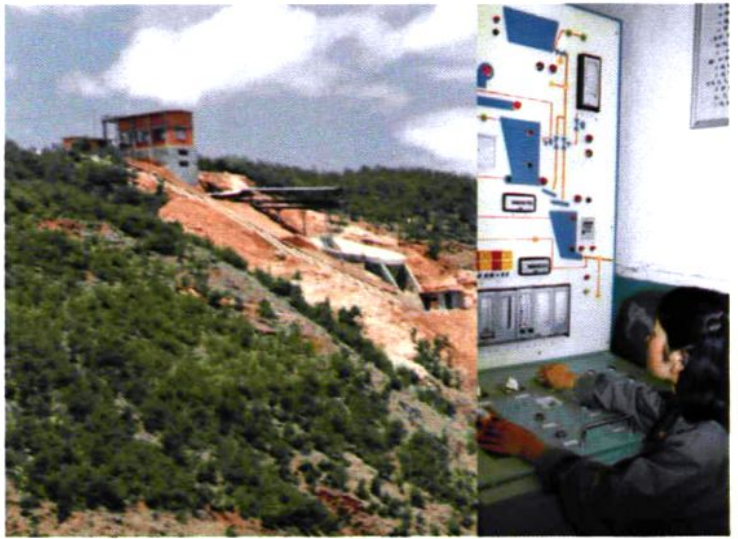
引進的粗粒級水砂充填技術，經消化改進達八十年代國際水平，獲中國有色工業總公司科技進步一等獎和國家科技攻關重大成果獎。圖為充填料制備站外景及總控臺。
