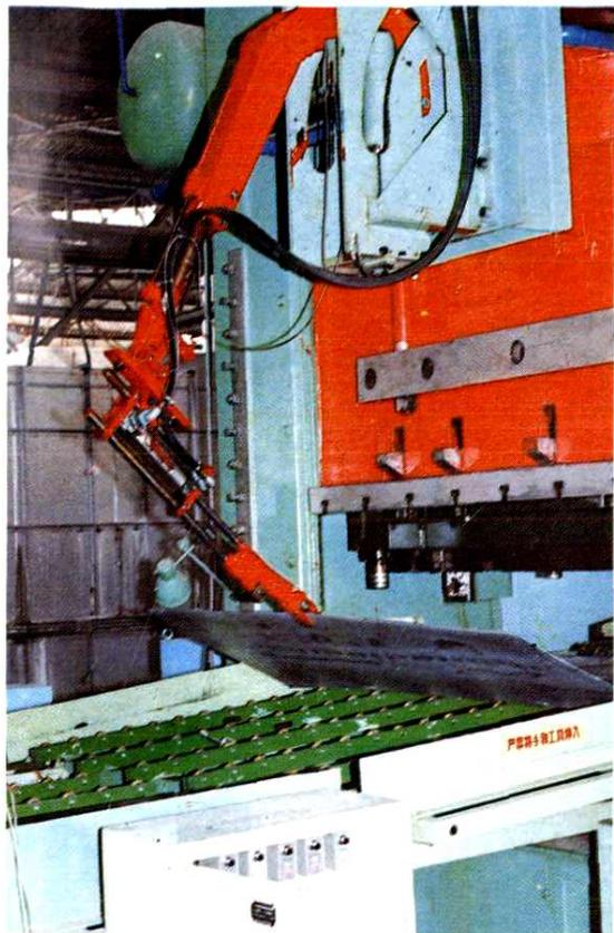
洗衣机箱体成型线上的机械手装置
