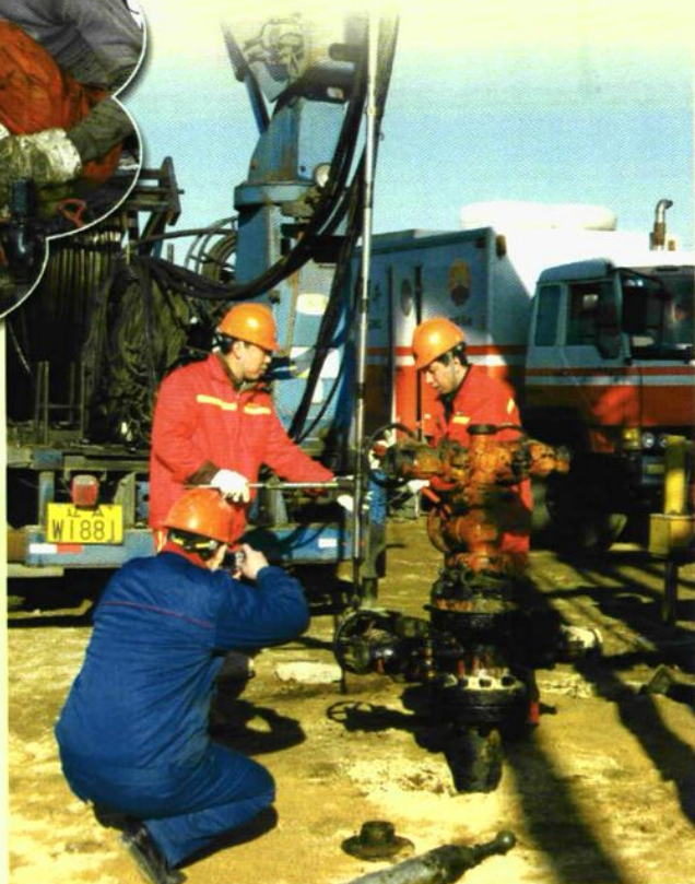
生产准备职工在操作连续油管车进行修井作业
