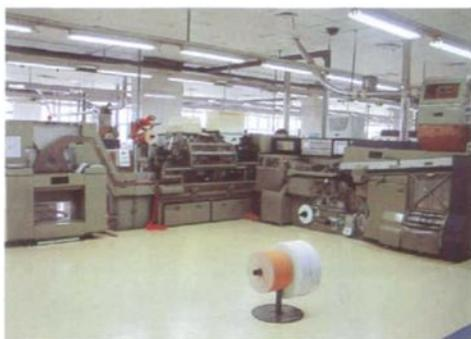
■ YJ15 卷接机组。1995 年购置，建昌机器厂制造；生产能力：6500 支/分，安置在二车间
