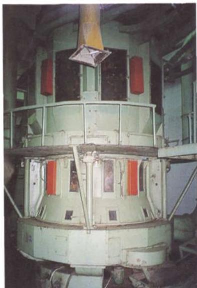
■ 立式打叶机。型号：YA4501；能力：3000 公斤/小时；徐州机械厂制造，1989 年 6 月购进、安装并投入使用
