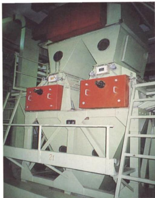
■ 卧式打叶机。型号：YA55/2；能力：3000 公斤/小时；徐州机械厂制造，1996 年 2 月购进、安装并投入使用
