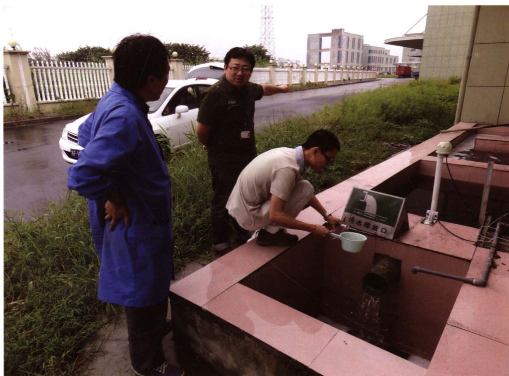
企业污水排放口采样检查（2012年7月）
