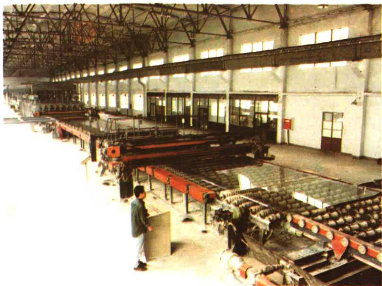
四川玻璃股份有 限公司新建日产 300 吨级浮化玻璃生产线
