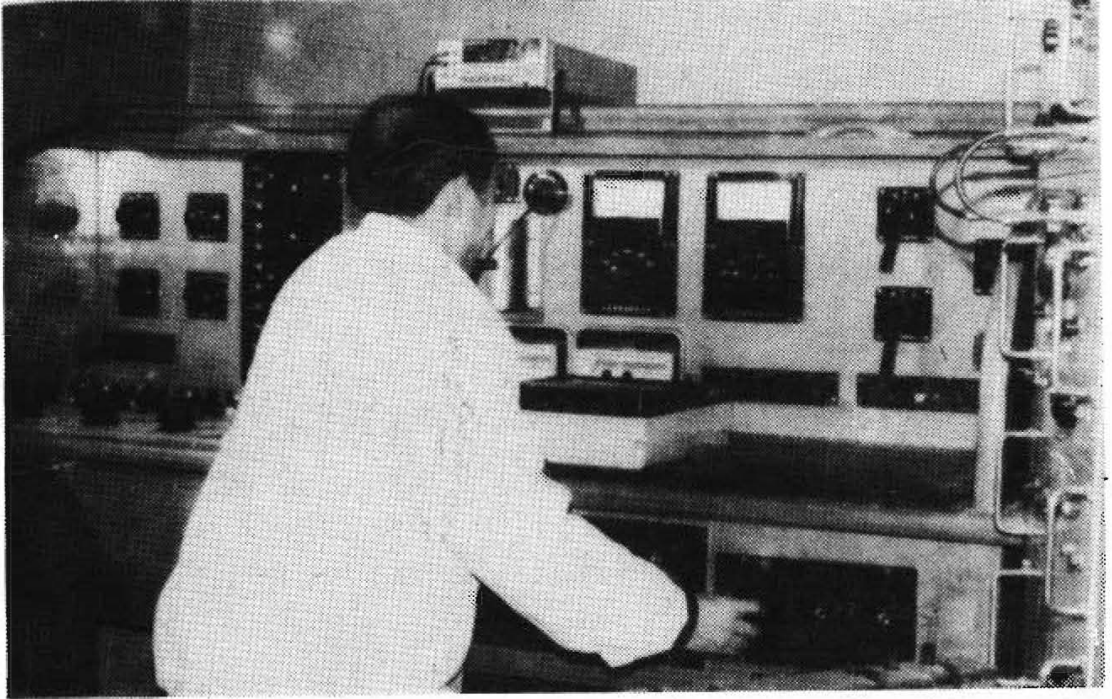
市计量测试所电学室交直流精密电表校验装置
