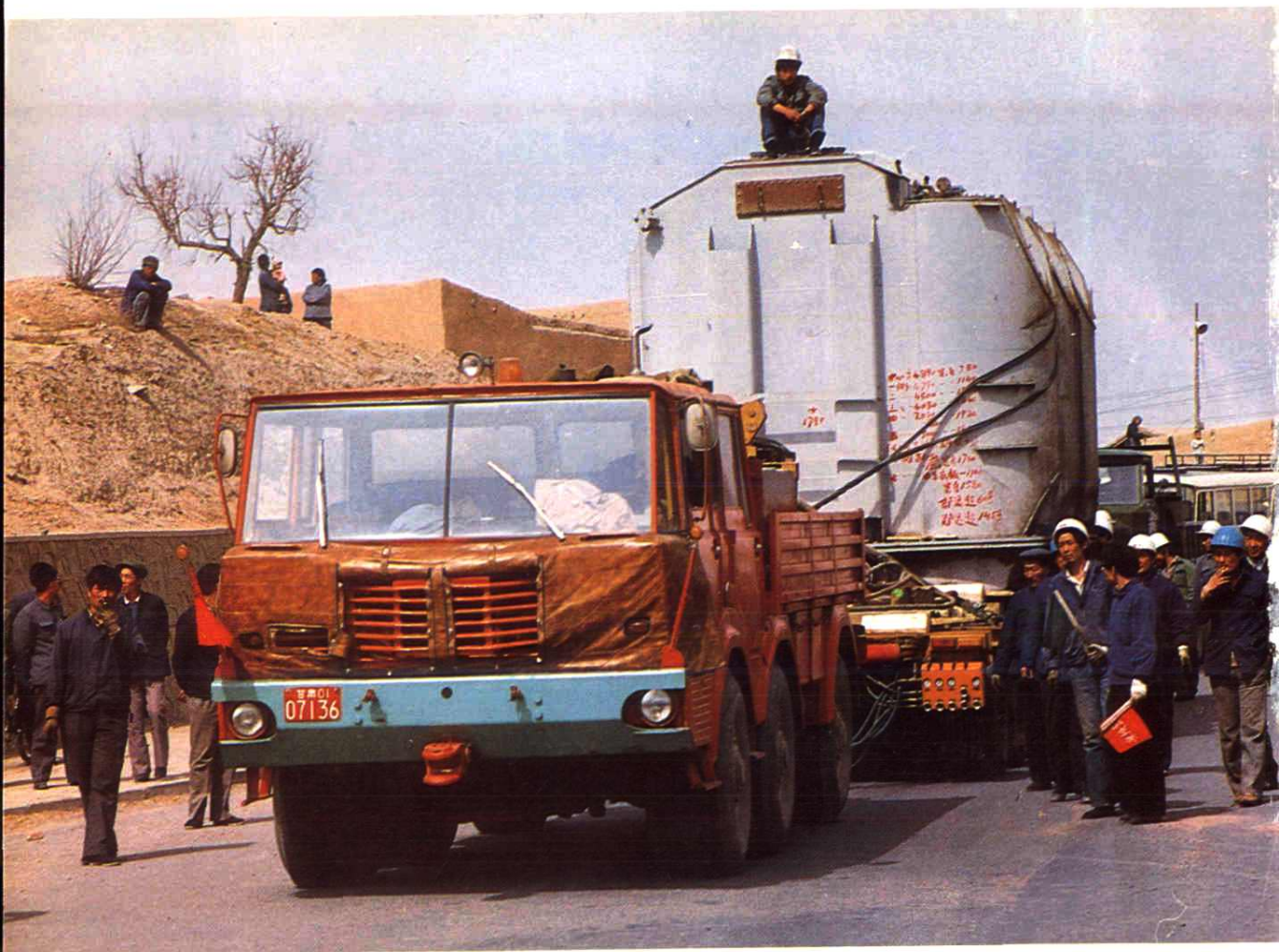
大型变压器在运输途中
