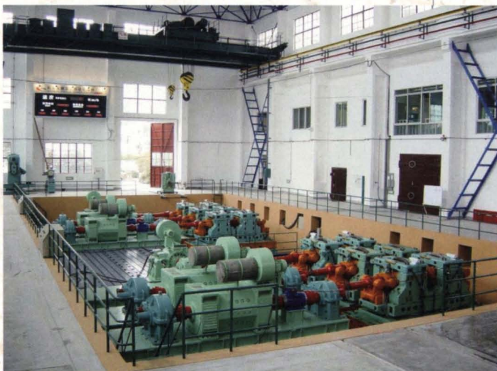
机车车辆整车滚动振动试验台
