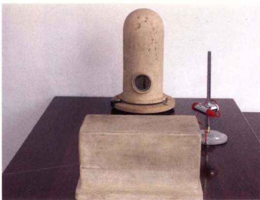
图 13 陶瓷偏角观测仪
