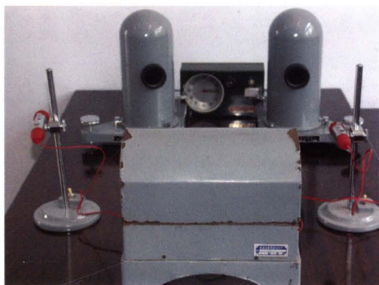
图 11 水平摆金属丝倾斜仪
