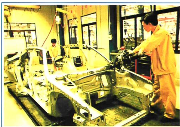
◀ 车身焊接断裂破坏性试验
