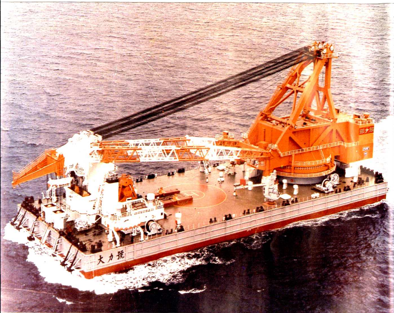
起吊能力达2500吨的海上自航浮吊船“大力号”
