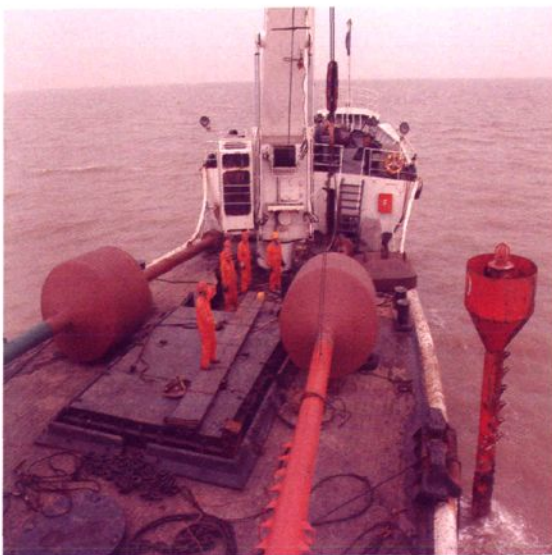
大型航标船海上航标抛设作业
