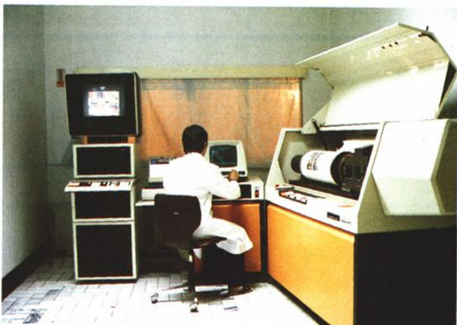
菏泽印刷厂建于一九五二年，是一个综合性的中型印刷厂。图为技术人员正在操作M645-IM电分机及彩色预打样装置。 桑秋华 摄
