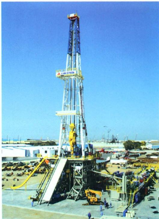
兰石制造的ZJ90DB直流变频电驱动钻机在科威特钻井公司井场
