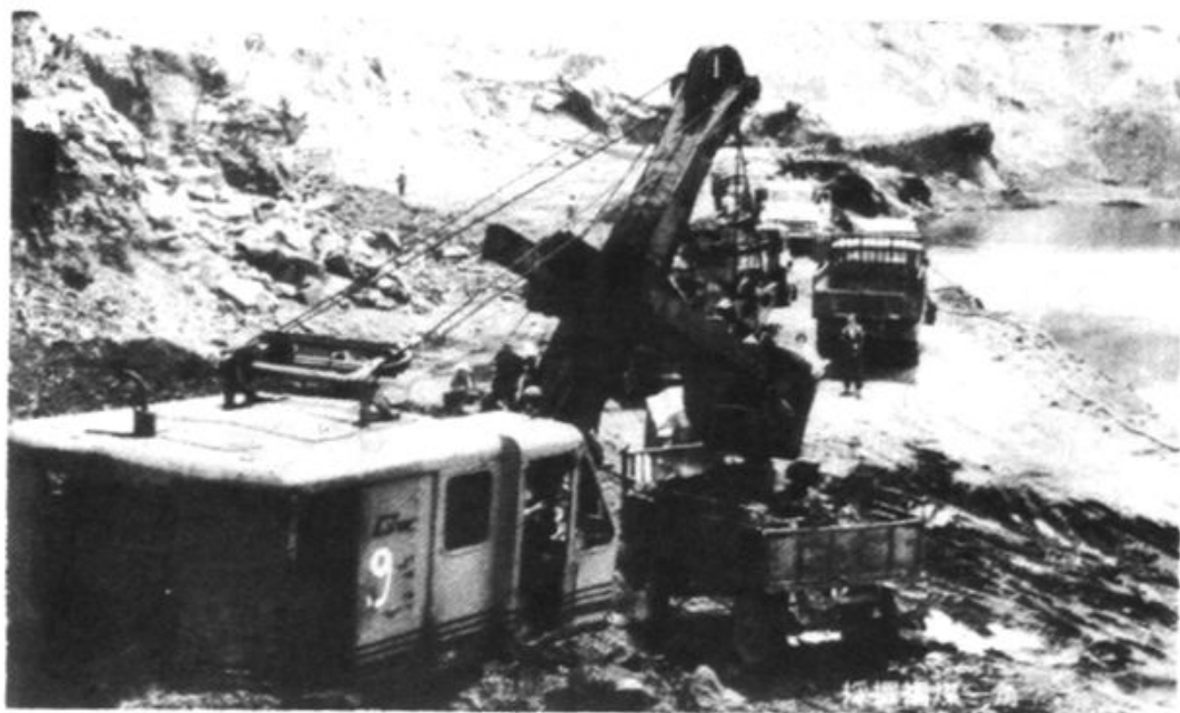
华宁县向阳煤矿机械化露天采、装褐煤
