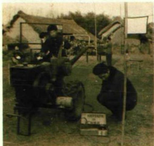
1975年，邗江头桥公社电影队以手扶拖拉机带动发电机发电，解决农村放电影缺电困难。
