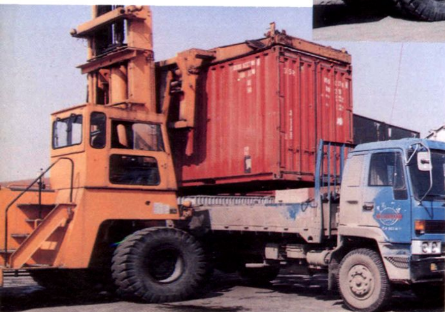
◀ 河南外运用汽车调运空箱
