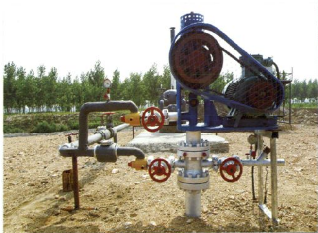
螺杆泵冷采技术成为低成本开发的有效措施
