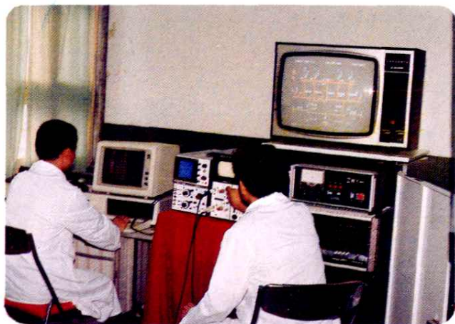
◀零陵地區電網運行微機監 視系統主站
