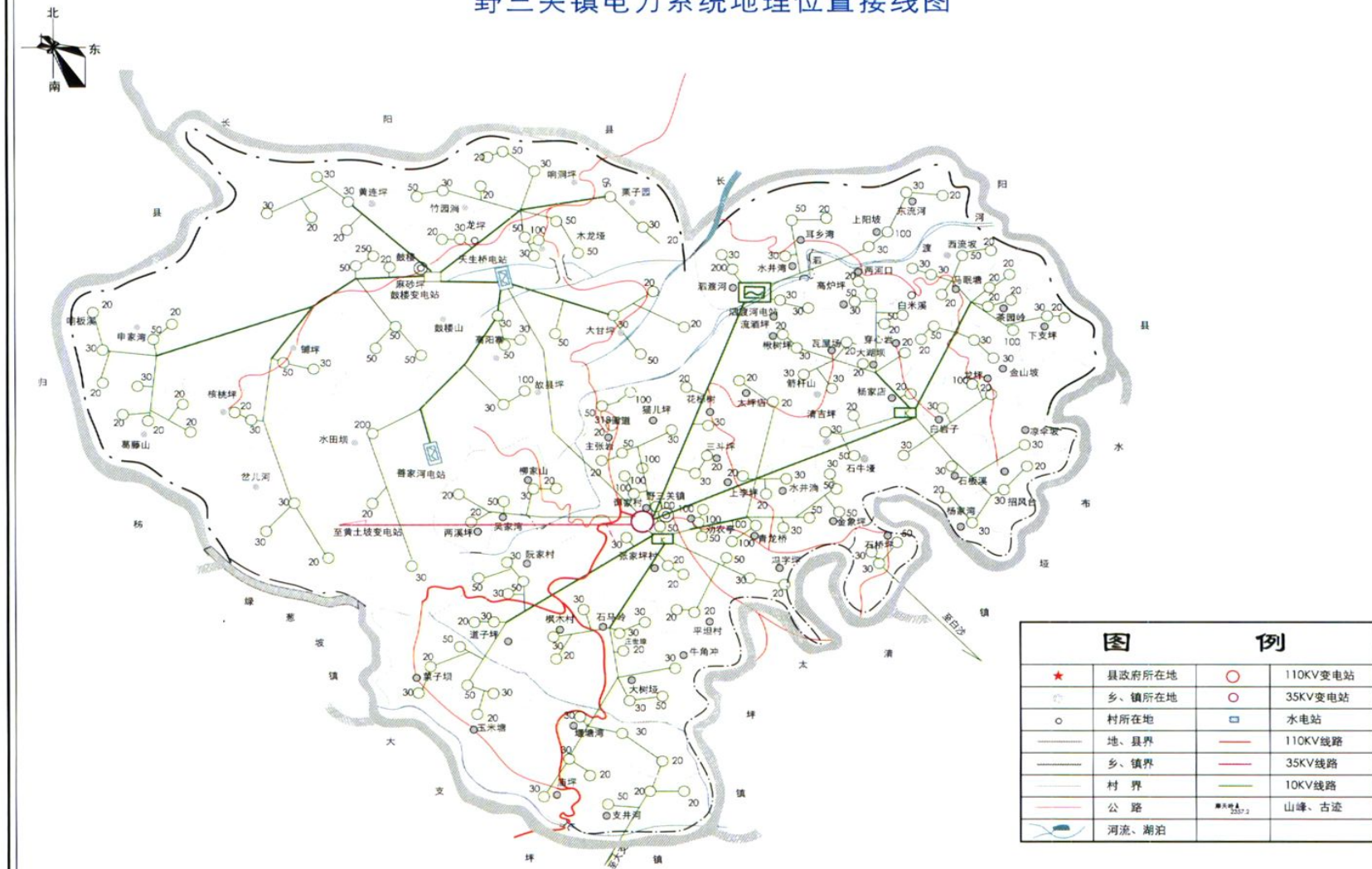
野三关镇电力系统地理位置接线图
