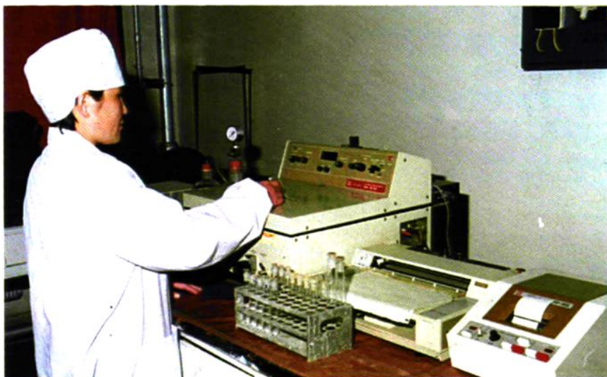
原子吸收分光光度计检测样品。
