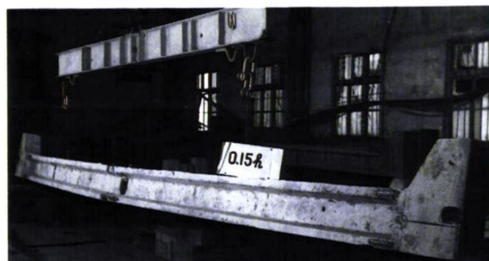
院科研所为承担国家编制规范进行的钢筋混凝土 I 字形截面长柱纵向弯曲试验
