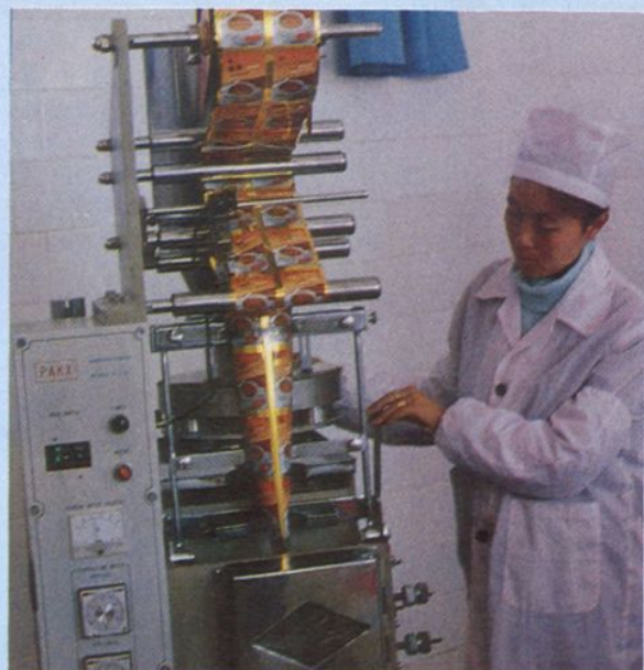
► 新产品速溶红茶、速溶奶茶自动包装机。
