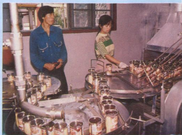
▲ 1995 年投产的易拉罐生产线
