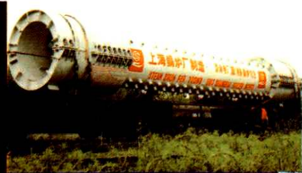
上海锅炉厂制造的 1025 吨 / 时锅炉汽包整装待运
