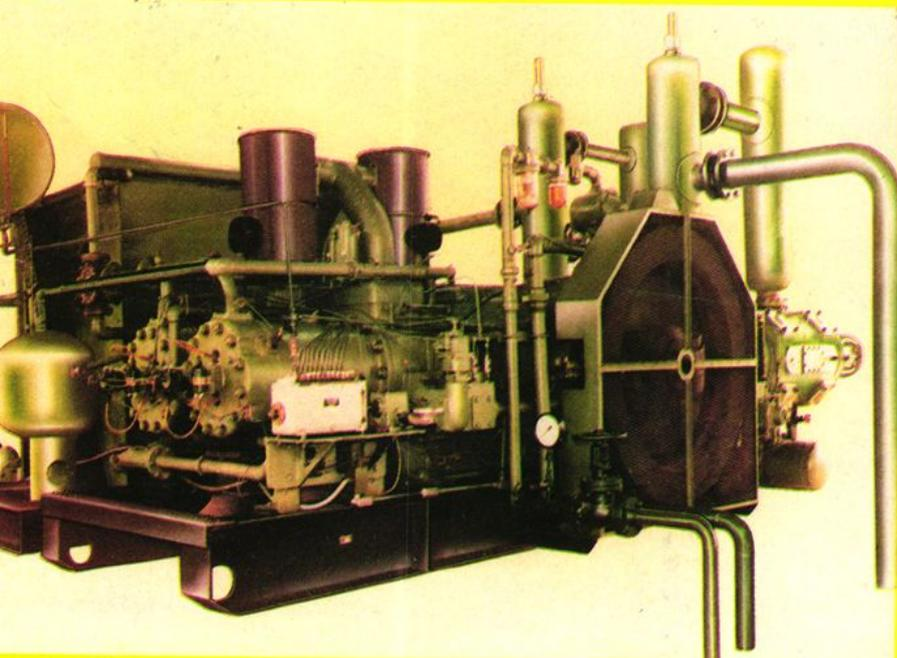
2MT10-2.8~11.4/45型燃气摩托压缩机
