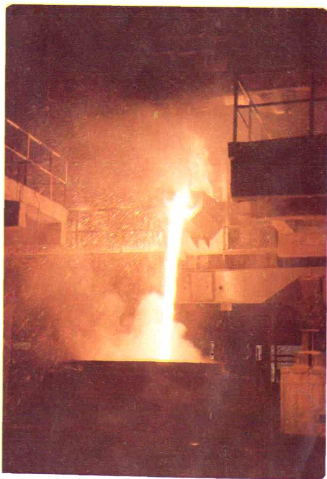
国家计委、冶金部“七五”期间重点攻关项目——不锈钢连铸，由江西钢厂，上钢五厂、上海钢铁工艺技术研究所共同合作，于1986年9月在江钢大方坯连铸机上试验，取得成功。
