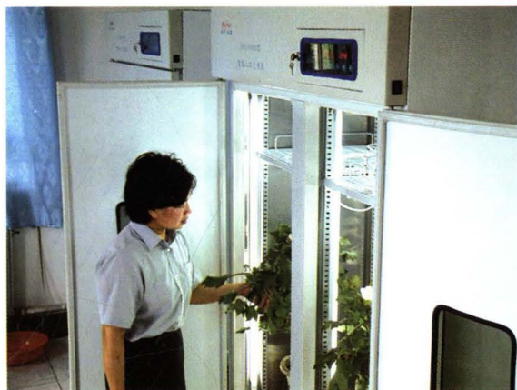
乌兰乌苏农业气象试验站利用人工智能气候箱进行棉花低温冷害试验
