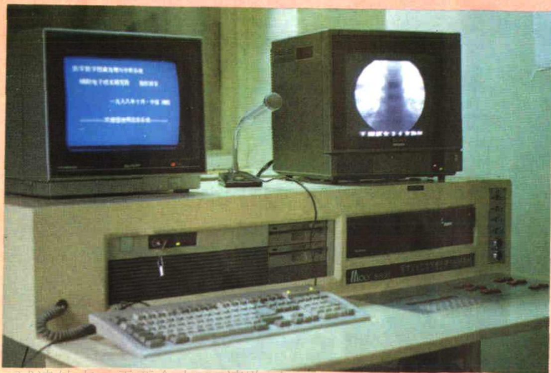
▽ 绵阳电子研究所研制的医用 X 光图像处理系统
