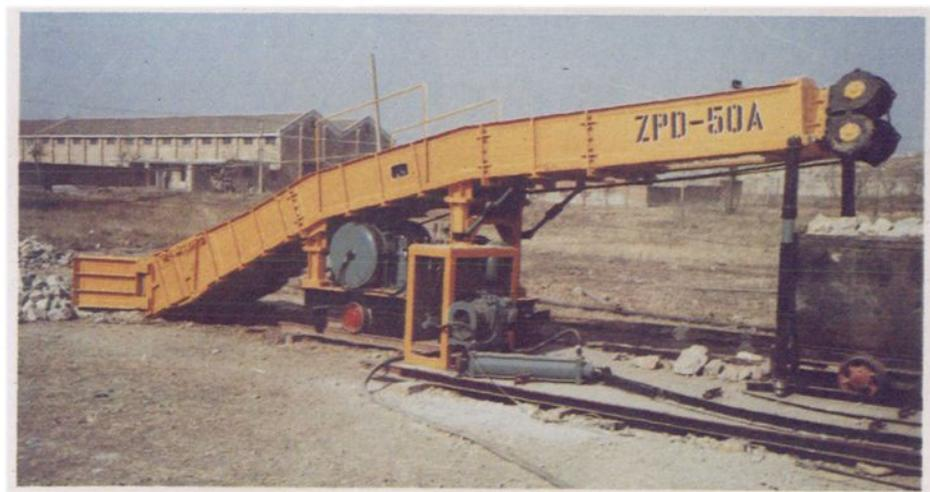
徐州煤矿采掘机械厂生产的ZPD-50A 液压耙斗装岩机
