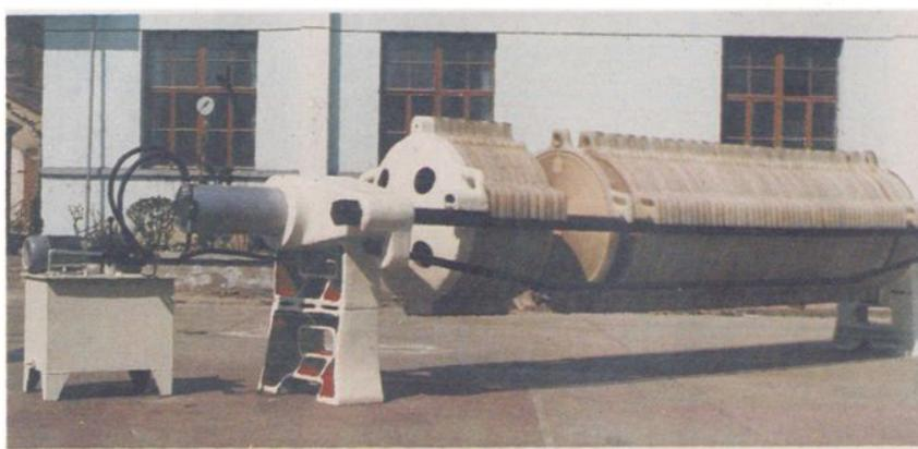
徐州轻工机械厂生产的BKAY820/65型膜式充气压榨机
