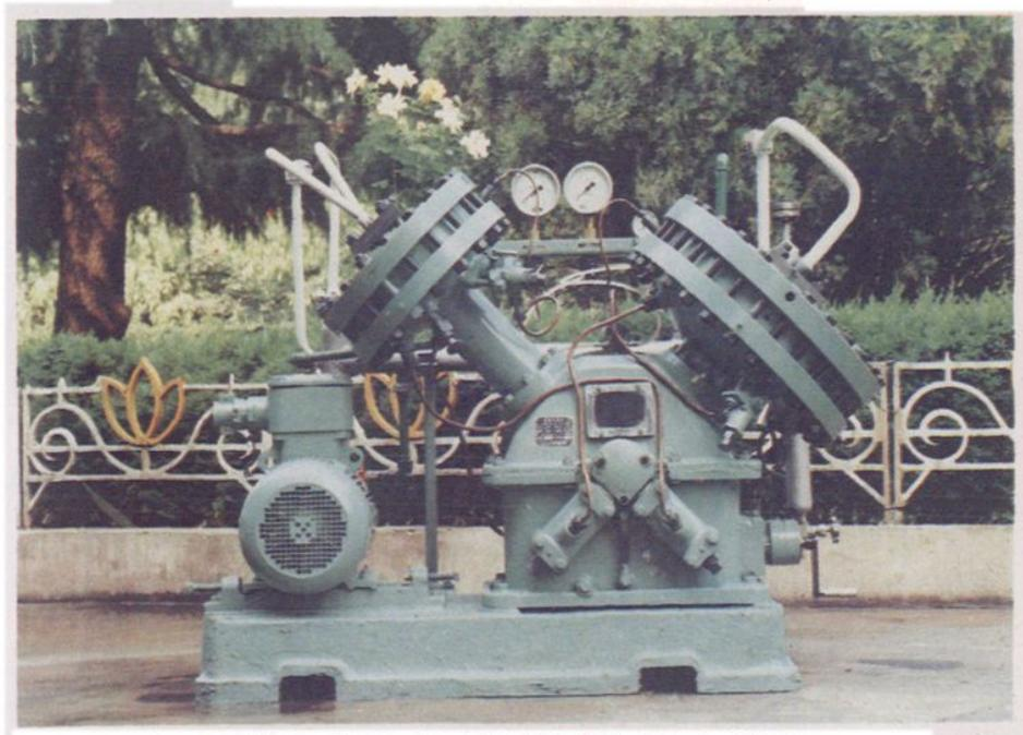
铁道部工程指挥部徐州机械厂生产的G2V—20/25膜压机
