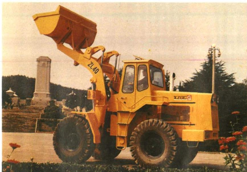
徐州工程机械制造厂、徐州第二工程机械厂生产的ZL40装载机
