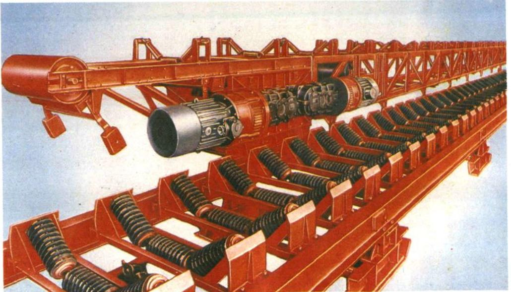
徐州矿务局第二机械厂生产的皮带运输机
