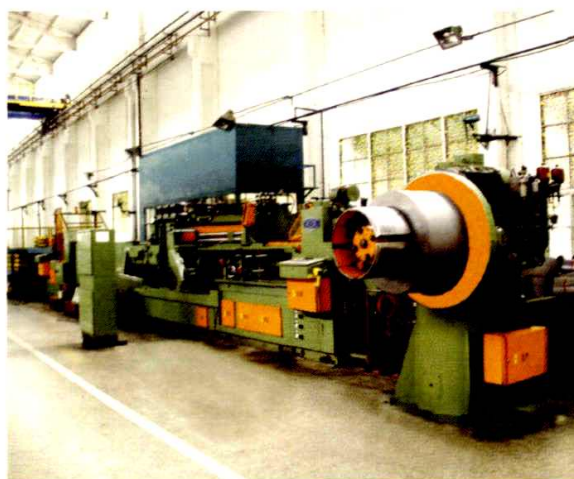
从德国乔格公司引进的TBA/ME800 × 5000硅钢片横剪线
