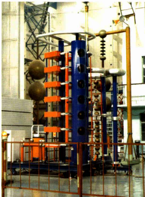
高压试验设备1050KV冲击电压发生器
