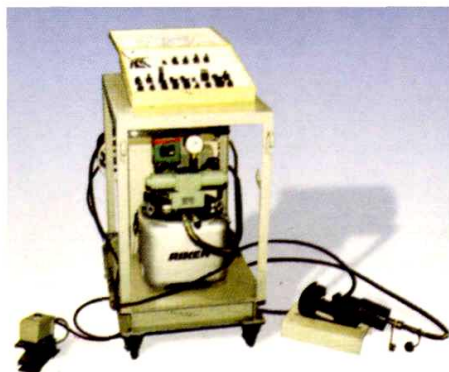
从日本理研及美国AMP公司进口的全套引线冷压接设备
