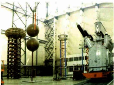
高压试验设备3000KV 180KWS冲击电压发生器
