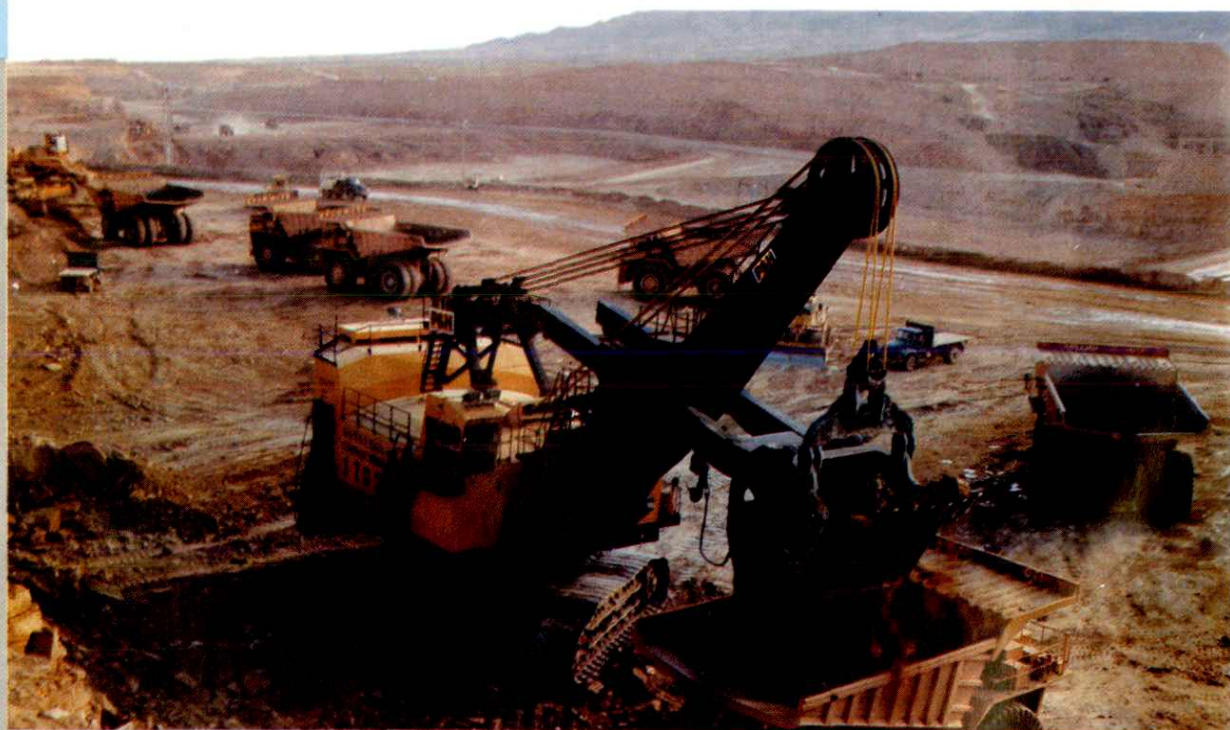
斗容 25 立方米的大型电铲和载重 154 吨的 170 型汽车在平朔安太堡露天煤矿进行剥离作业
