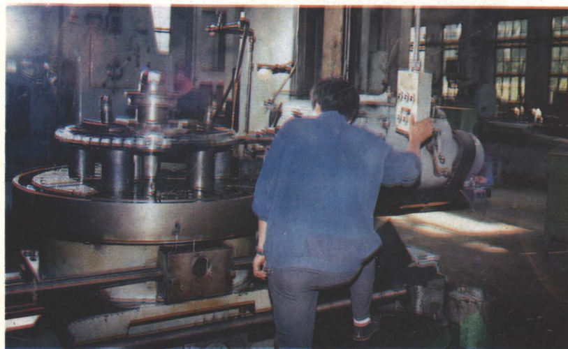
自制铣床加工链轮
