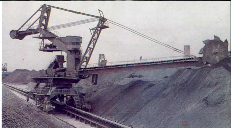
国产 ZL-1 型斗轮式堆取料机 (酒泉钢铁公司)
