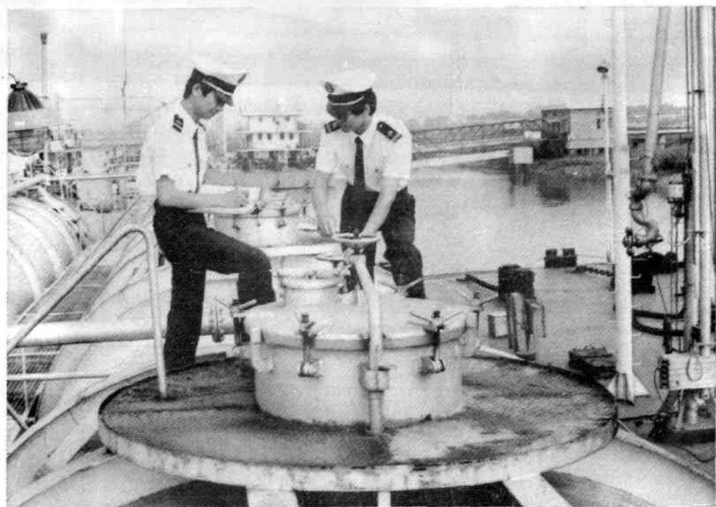
检查装载危险品的安全设施
