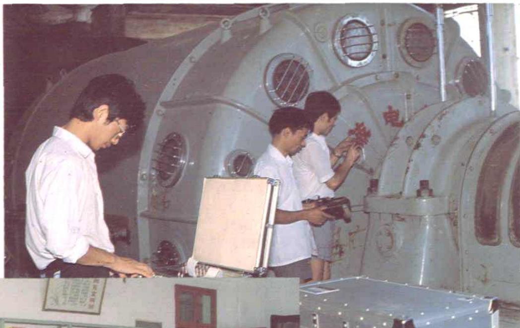
技术人员在现场进行 机组振动测试
