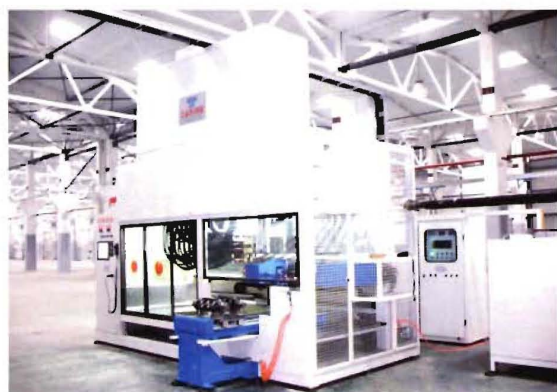
十堰天舒机电公司自动曲轴淬火机床(2007年 摄)
