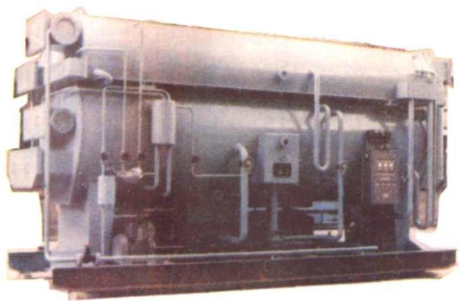
通用机械厂生产的150型蒸汽两效溴化锂吸收式制冷机
