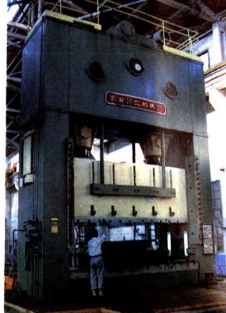
▲ 大型冲压设备之一——800吨双点闭式压力机
