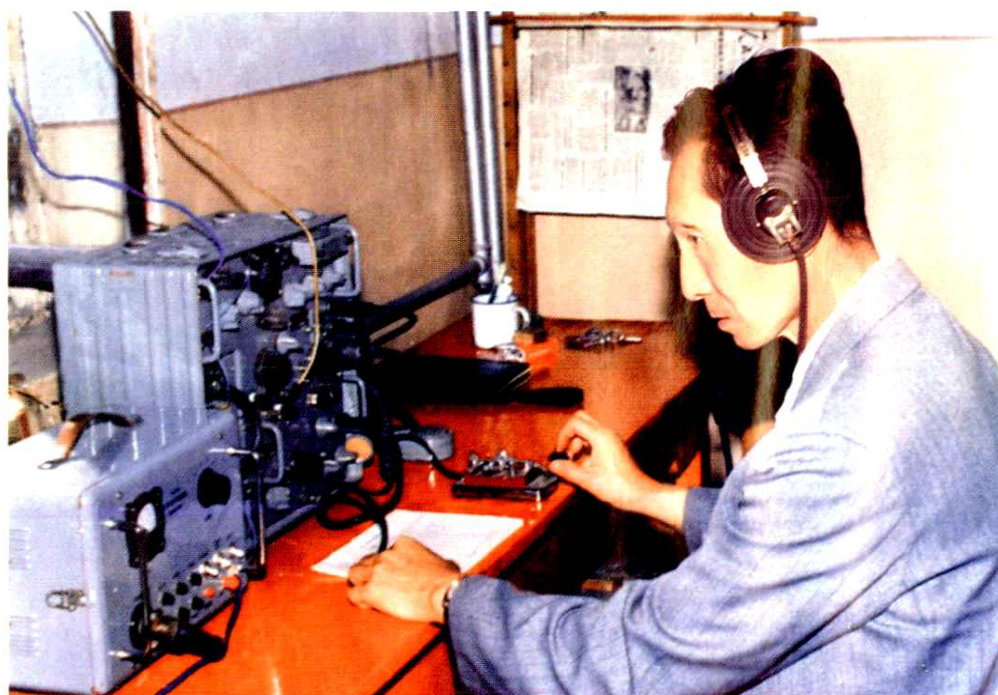
15W 小型无线收发报机在 1950 至 1990 年期间,为我省森林调查、矿产开采、水文、气象情报通信中发挥了重要作用。图为报务员马云飞在偏远矿区连续工作 40 年
