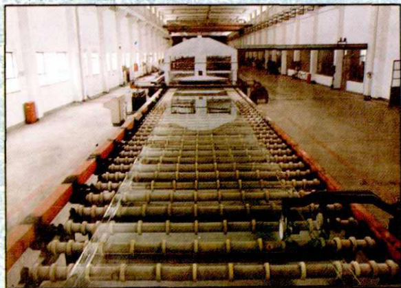
1991年12月建成的上海平板玻璃厂的国产浮法生产线
