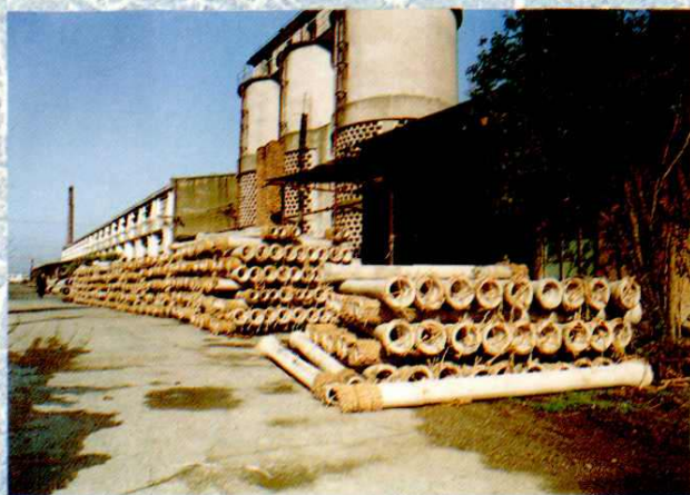
上海新型建材厂1976年生产的自应力混凝土压力管
