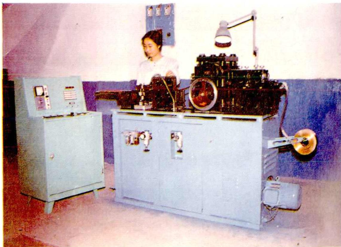
湖南水箱厂自行设计和制造的水箱用波纹带自动滚轧机。图为工人正在操作。
