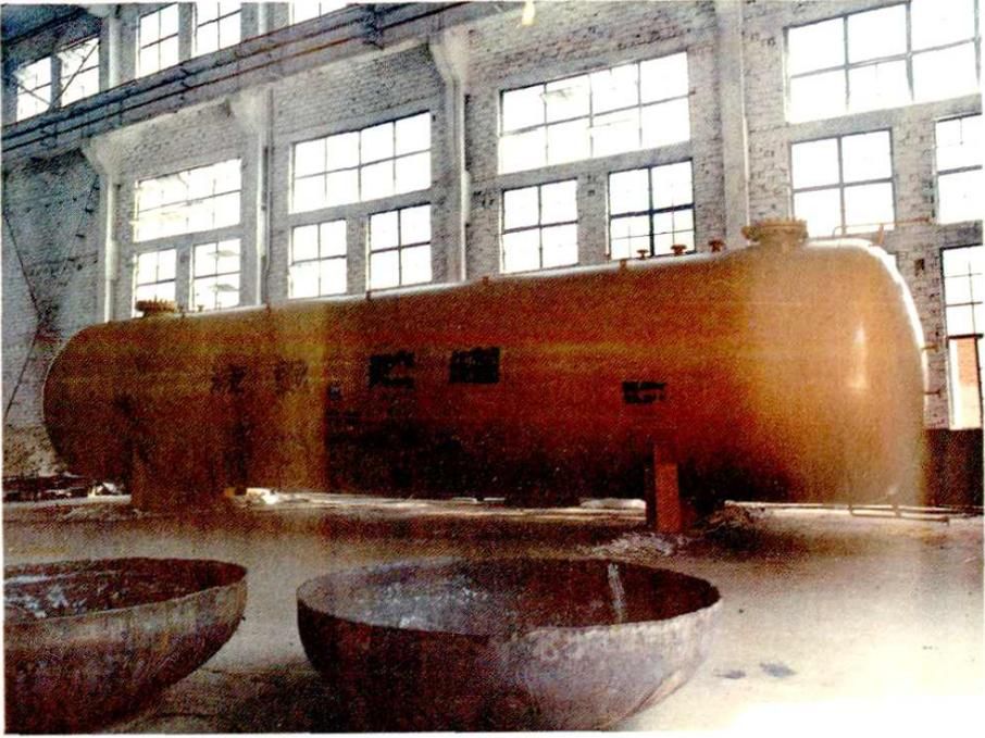
江苏省化工设备制造安装公司生产的三类压力容器贮罐
