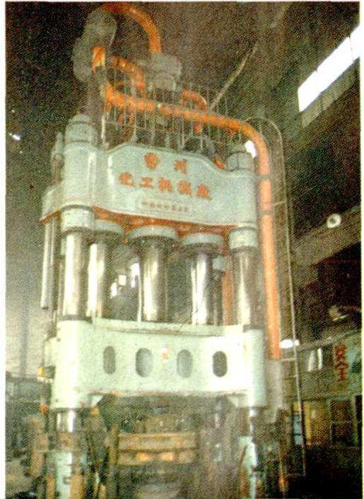
常州市化工系统最重的大型机械设备：常州化工机械厂的1500吨水压机。
