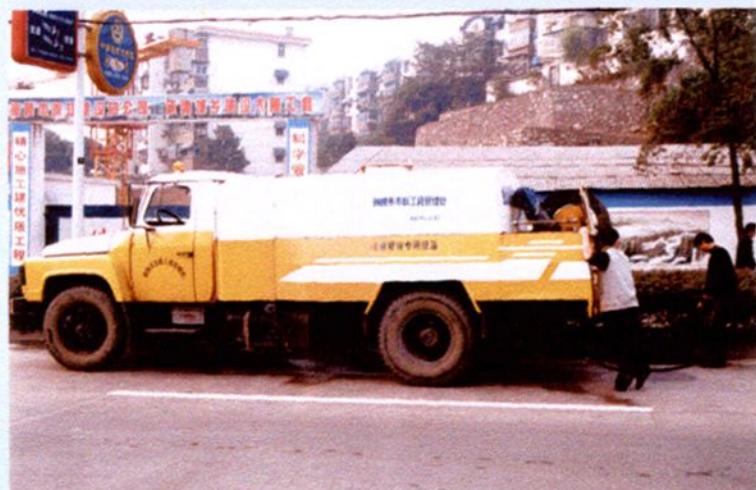
排水养护管理所下水道疏通车在疏通雨水井（2000年）
