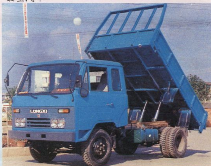
龙溪 1.5 吨双顶缸液压自卸车
