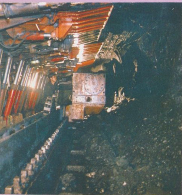
六道湾煤矿国产综采工作面
